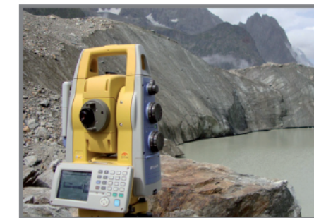
Stazione Totale TOPCON IS Rilievo di una Cava
